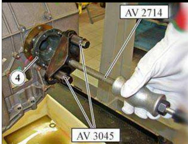
● 使用提供带销 (AV 3045)的滑动锤拉拔器 (AV 2714)，连同支撑部件，从变速箱拉出右侧差速器轴(4)。
