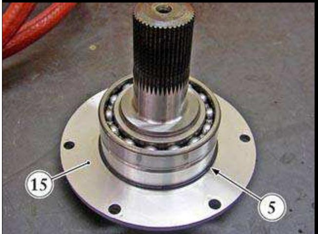
● 使用变速箱油润滑O形圈(5)并安装到盖(15)上。
