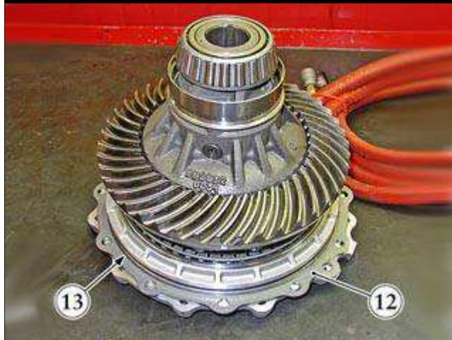
● 将新的O形圈(12)和垫片(13)安装到左侧盖上。
