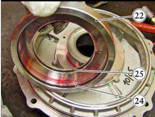
● 在浮动衬套(22)内, 有两个密封圈, (24)和(25), 它们各自由两个元件组成, 每次在拆卸它们时应该进行更换。
