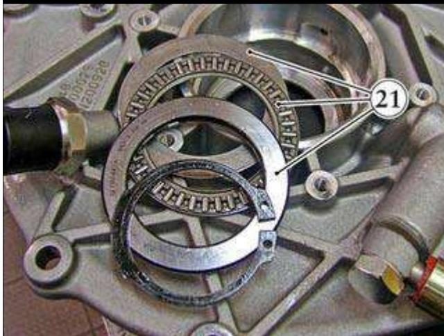
● 拆卸止推轴承(21)的3个部件。
